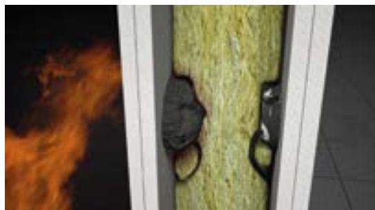
Демонстрация поведения противопожарной приборной коробки.
